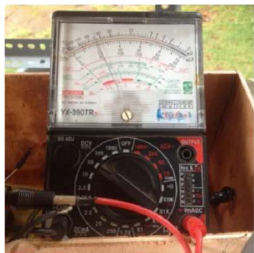
Gambar 11. Pengukuran Tegangan dengan Multitester
