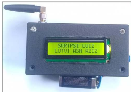
Gambar 5. Remot untuk mematikan / menghidupkan sepeda motor
