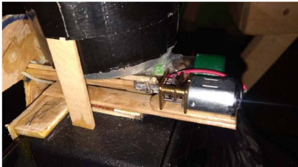
Gambar 12. Pemasangan Motor DC 12-N20
