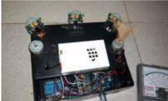
**Gambar 12.** Pengujian relay dan motor DC menggunakan multimeter
