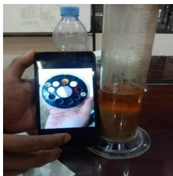
Gambar 2. Hasil Pengujian Kandungan Zat Organik Pada Agregat Halus.
