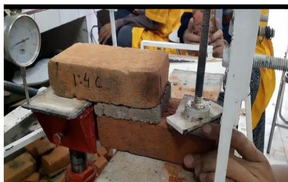
**Gambar 5.** Pengujian Lekatan Pasangan Bata
