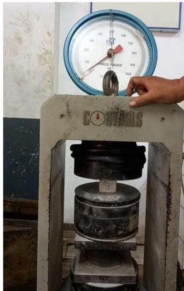
**Gambar 3.** Pengujian Kuat Tekan Mortar
