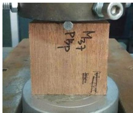
**Gambar 2.** Pengujian kuat tumpu paku
