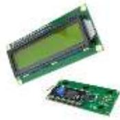
Gambar 6. LCD 16x2 dengan I2C
