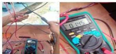
Gambar 14 Pengujian panel surya
