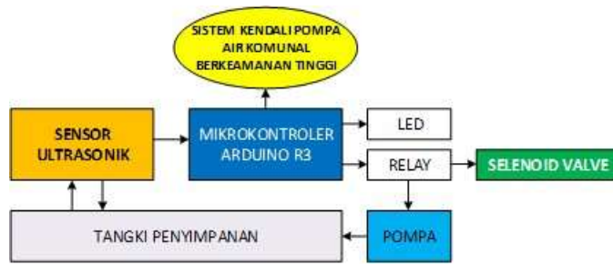
Gambar 4. Diagram blok sistem kendali pompa air berkeamanan tinggi
