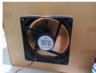
Gambar 11. Gambar Exhaust fan dalam Keadaan Menyala
